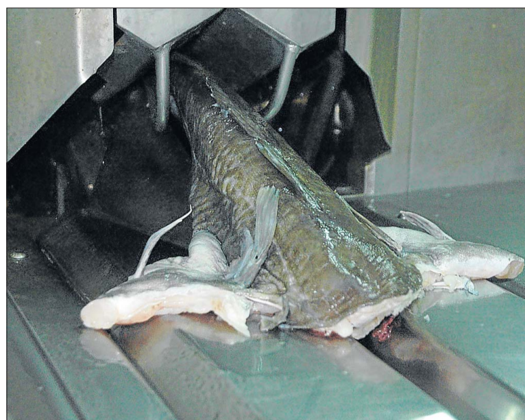
Les morceaux sont découpés au laser.
